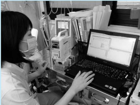
輸液ポンプ専用の精度分析機
